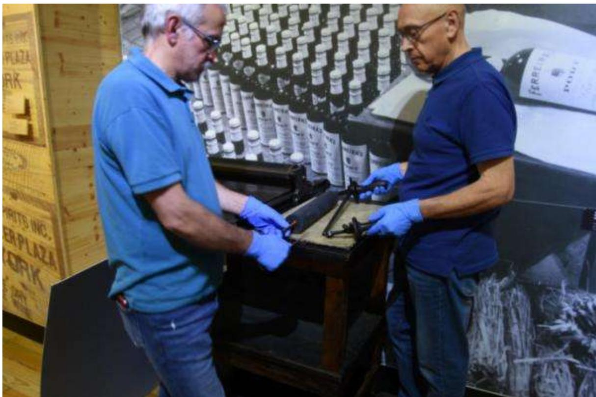
Intervenção de restauro da impressora Minerva e do prelo de impressão doados pelo Sr. Mário Joaquim, da Imprensa do Douro. Esta operação teve como propósito restituir a funcionalidade destes dois equipamentos, além de ser feita uma manutenção geral das mesmas, com montagem e desmontagem dos componentes. Refira-se que a vulcanização dos rolos só foi possível graças ao **mecenato** da **empresa Indurrols**, que graciosamente vulcanizou borracha nova nos rolos originais.
